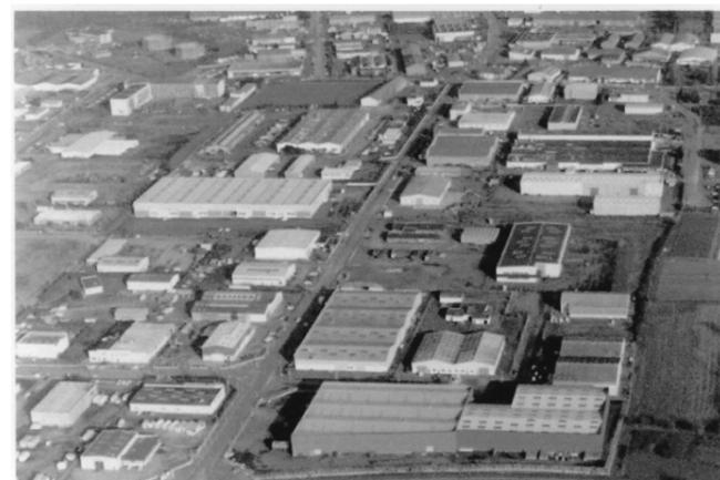
Figure A.7 — Rugosité IIIb (Zone industrielle)
