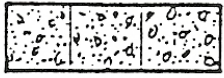
Agglomérés et béton manufacturé pointillés fins avec semis de cailloux et représentation des joints.
