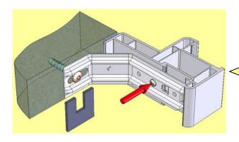
Pattes équerre d'épaisseur 1,5 mm et de largeur 40 mm avec 2 nervures de hauteur 5 mm
