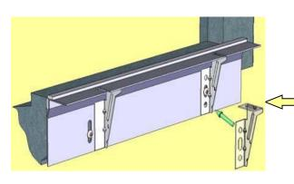
En l'absence de regingot utilisation d'une cornière filante de 1.5 mm d'épaisseur mini. 💴 sur toute la longueur de l'appui. Elle peut-être renforcée par des goussets
