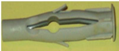
Cheville d'ancrage en nylon à ailettes, pour plâtre et matériaux creux. Lors du vissage, les ailettes se **déforment** et s'ancrent dans le mur. Particulièrement adaptée aux matériaux creux, pour des charges de moins de **20**. kg.
