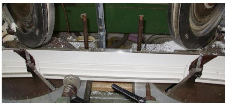
Des tronçonneuses spéciales réalisent des découpes en V, permettant le soudage de traverse ou de meneau.
