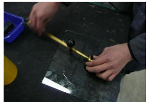
50 - **Tapoter** le dessous pour **détacher** le verre sur le trait de coupe. L'alcool s'infiltré alors par **capillarité**. On peut aussi **retourner** le verre et appuyer avec les pouces sur le **trait** de coupe pour faire **filer** le verre. Pour faciliter le détachement, on peut effectuer 4 traits de coupe vers l'**extérieur** de la pièce.
