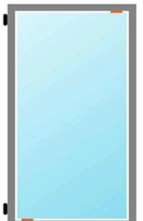
60 - **Réutiliser** les cales existantes et si nécessaire compléter par d'autres. Vérifiez que l'ouverture et la fermeture se passe sans **frottement** et modifiez le calage si nécessaire.
