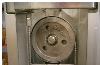
Poulie acier avec protection du câble
