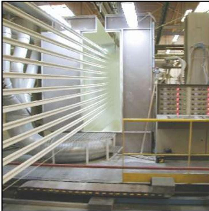
Ces traitements sont suivis de **rinçages** appropriés avant passage dans une étuve de **séchage**.
