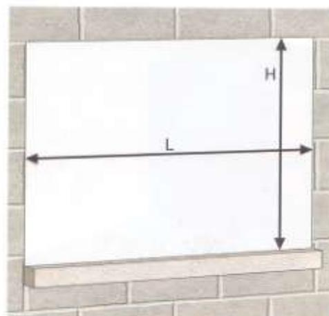
b) Vérification des dimensions du châssis :
