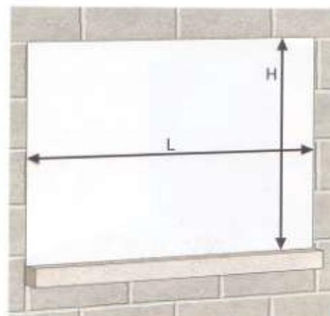
b) Vérification des dimensions du châssis :
